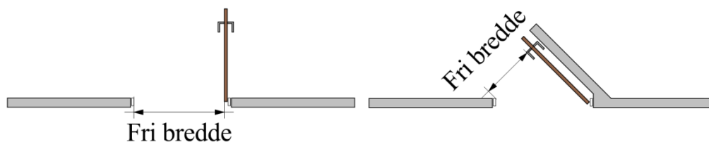
Figur 2.24. Måling af en dørs frie bredde ved henholdsvis en åbning på 90° og ved åbning på mindre end 90°.
