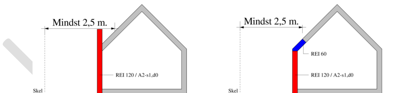
Figur 4.19. Brandvæg ved skel. Venstre side viser brandkam og højre side viser brandkammerstatning. Alle klassifikationer er minimumskrav.
