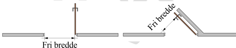
Figur 2.14. Måling af en dørs frie bredde ved henholdsvis en åbning på 90° og ved åbning på mindre end 90°.
