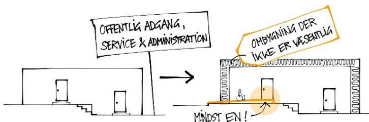
Figur 14: Eksempel hvor efterisolering af bygningen ikke berører egentlige tilgængelighedskrav, men alligevel kan udløse tilgængelighedskrav efter BEK 1250.
