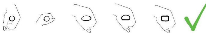
Figur 7: Tilnærmet cirkulære eller afrundede tværsnit med diameter svarende til 30-50 mm, som både kan gribes om med en voksens hånd oppefra og med en barnehånd fra lav højde. Profilerne monteres så vidt muligt fri af understøtninger, så hånden kan lukke helt omkring profilet i et kraftgreb.
